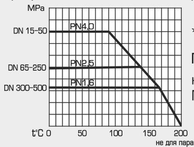
\* каталожные обозначения для кранов стандартного исполнения из ст20
